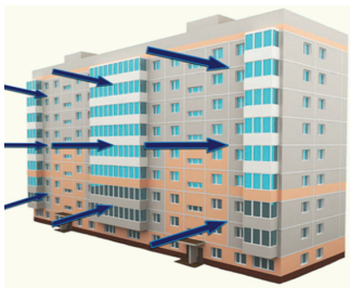
Рис. 1. Условное изображение силы динамического давления ветра на фронтальную поверхность здания
