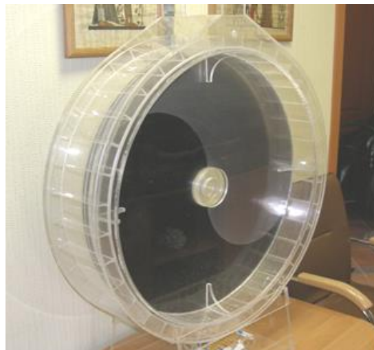
Рис. 1.9. Действующий опытный макет гидрокольцевого двигателя
