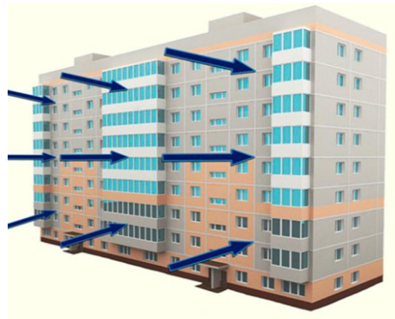
Рис. 1.10. Условное изображение силы динамического давления ветра на фронтальную поверхность здания
