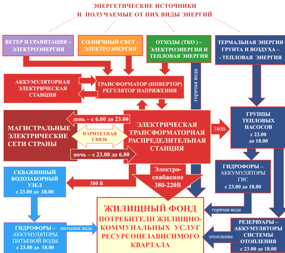
Рис. 3.1. Принципиальная схема энергоактивного кластера
